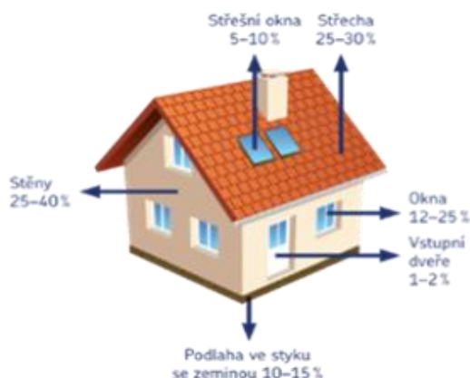
Obr. 35 Tepelné ztráty RD (zdroj: URSA CZ)
